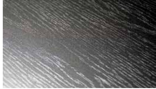
Abb. 8: Pressblech für die Laminatproduktion
