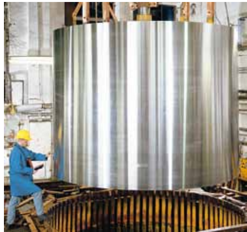
Abb. 7: Verchromter Zylinder mit mehr als drei Metern Durchmesser
