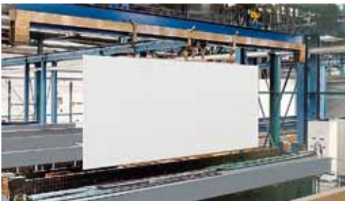
Abb. 5: Beschichtung großformatiger Bleche
