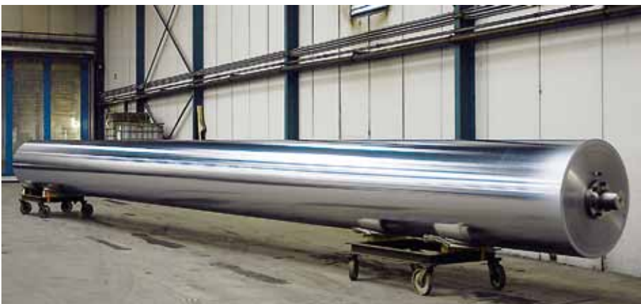
Abb. 6: Bisher längste oberflächenveredelte Walze mit einer Sonderlänge von 14 Metern
